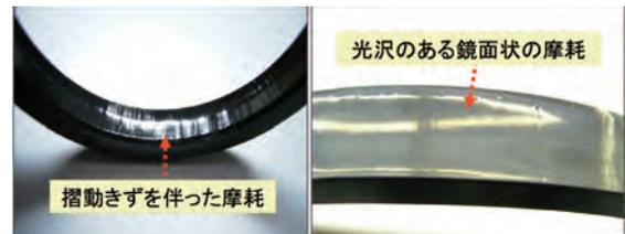
パッキンの使用中に漏れや動作不良、鳴きなどが起こる場合、パッキンには、はみ出し（かじり付き）、破損・クラック、摩耗、劣化、変形などの現象がみられます。それぞれの原因究明と対策が必要となりますが、ここでもFEAによる解析が有効です（図7.FEAを用いたパッキン設計例）。
