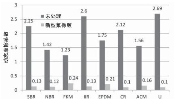
试验方法：球状压头试验机，试验速度：60mm/min
