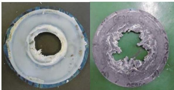
Figure 1 树脂类密封垫片开花现象的示例
