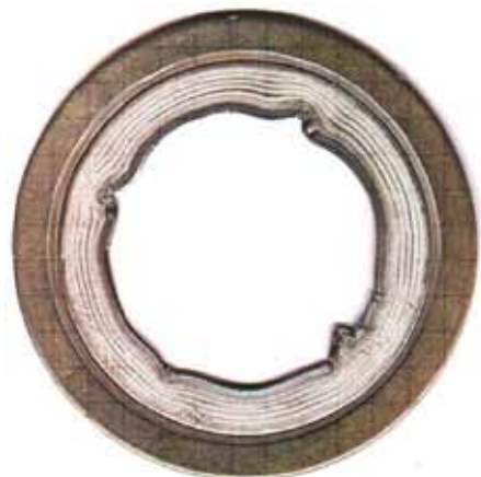
Figure7 缠绕式密封垫片的变形
