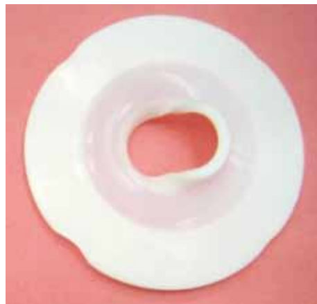
Figure6 氟树脂板材密封垫片的变形
