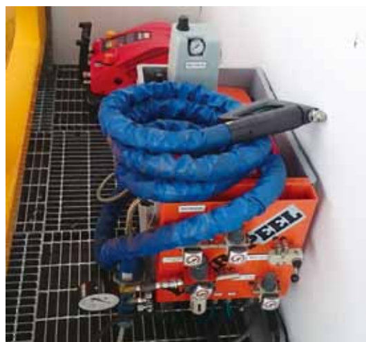
Figure4 特殊防锈施工单元
