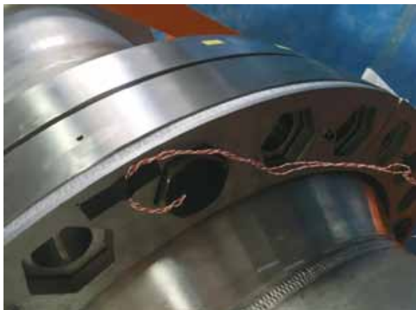
Figure1 24 英寸管法兰连接体的实验装置
