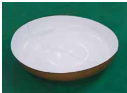
Figure3 大型槽罐的封头部分衬里
