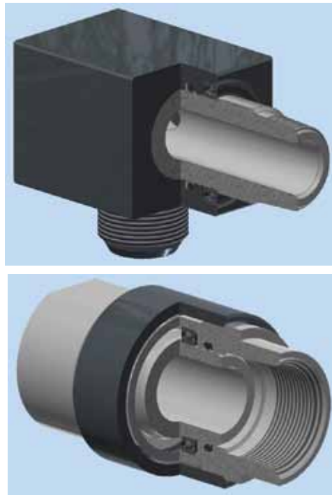
Figure1 LFR JOINT的切割模型图
