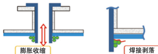
Figure14 喷嘴的温度变化引起的举动和损伤示例
