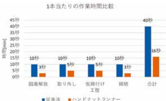
Figure8 作業工数の比較結果
