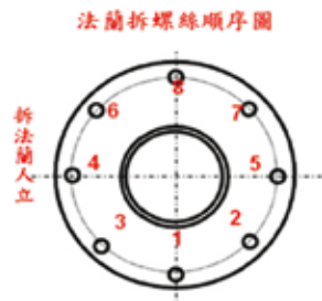
Figure5 ボルトの取り外し順序
