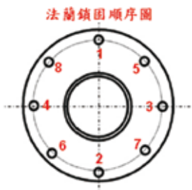
Figure4 フランジの固定順序
