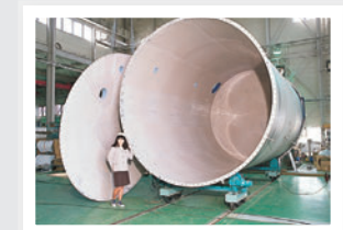
1982年 当時、日本最大級のふっ素樹脂ライニングタンク
