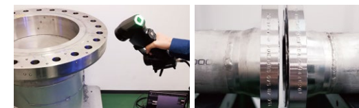
左：ハンディ型3Dスキャナでフランジの凹凸状態を計測 右：フランジの開き度合いも算出可能
