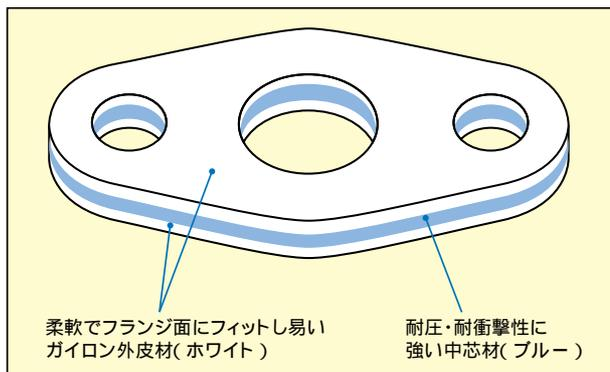
ガイロン 3565包みガスケットは、外側の柔軟な、なじみ変形するガイロンと内側の優れた耐圧・耐衝撃性をそなえたガイロンを組合せてサンドイッチ構造にしました。
