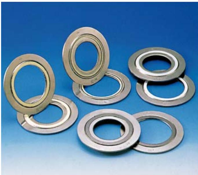
うず巻形ガスケットは高温・高圧用として合理的に設計された高性能のセミメタリックガスケットです。豊かな弾性を有し、装着厚さで締付力を規制できる利点から、火力・原子力発電所やスチームタービン船の蒸気系はもちろん、石油精製・石油化学工業のプロセスラインや熱媒体油ラインに広く使われています。
