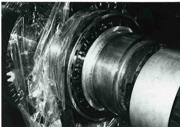
写真-3 「メタル・スリーブ取り付け部」
