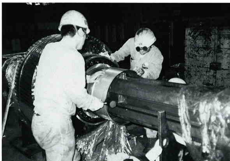
写真-2 「メタル・スリーブの取り付け」
