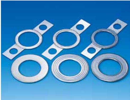
メタルジャケットガスケットは、耐熱フェルトなどの中芯材（クッション材）の外側を金属薄板で被覆したセミメタリックガスケットです。任意な形状に製作可能ですので、異形フランジや熱交換器のガスケットに適しています。断面形状が平形と波形の2種類あり、バルカホイル製の“のり付きギャザーテープ（No.VF-70）”または“シート（No.VF-30）”を貼り付けし、シーリング性を高めたものも製作しています。
