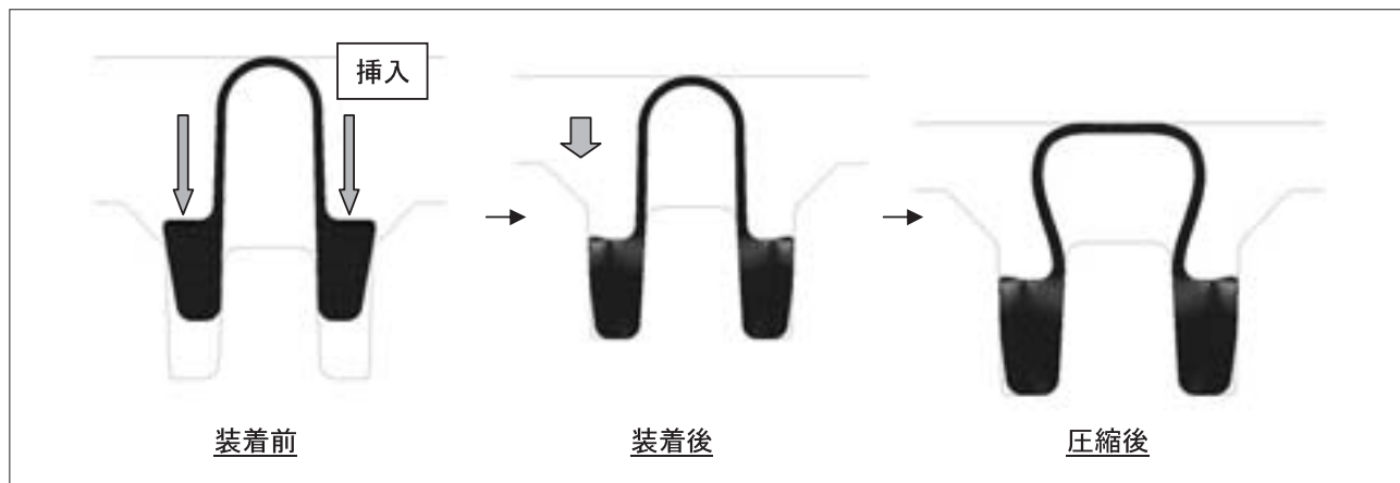
図2 URP用シールのFEA解析変形図
