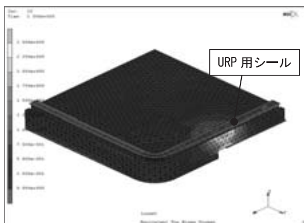
図3 URPヒンジ部変形によるシールへの影響FEA解析（一例）
