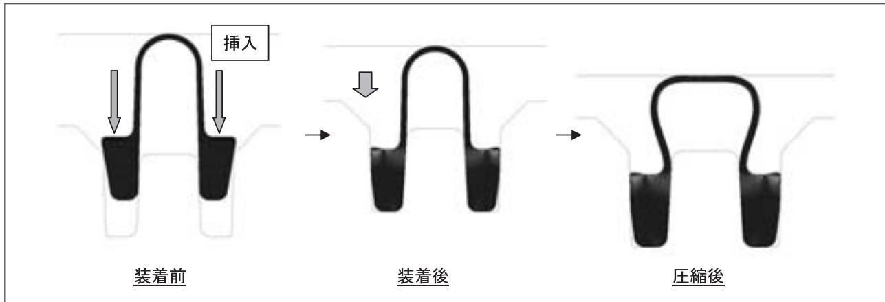
図2 URP用シールのFEA解析変形図
