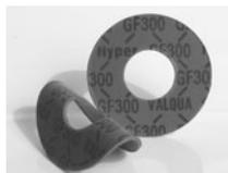
耐薬品・耐熱に優れる高性能タイプの製品。熱劣化の要因であるゴム分を含まないので、高温部でも安心して使用できます。圧縮破壊強度、柔軟性の改良に成功し、新しいタイプの高性能非石棉シートガスケットとして、石棉代替製品の切り札になります。
