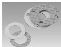
可溶性塩素を低減した白色ジョイントシートで、ステンレス鋼フランジの腐食抑制効果があります。表面処理によりフランジへの固着が低減されています。
