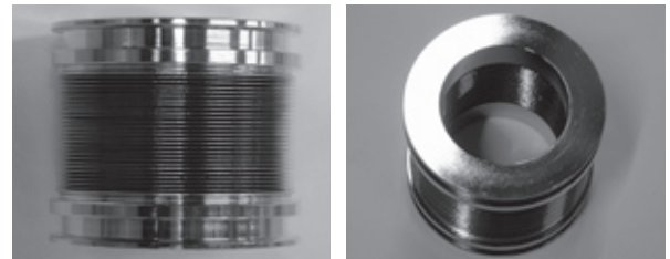
内径40mm, 外径60mm, 板厚0.12mm, 山数28山 図6 耐久試験用Al 2 O 3 不動態処理溶接ペローズ
