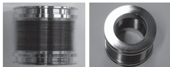
内径40mm, 外径60mm, 板厚0.12mm, 山数28山 図6 耐久試験用Al 2 O 3 不働態処理溶接ペローズ
