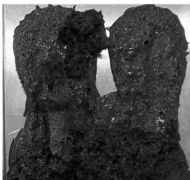
Figure5 FFKM200℃蒸気溶解写真
