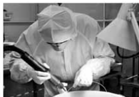
Figure2 ふっ素樹脂の溶接加工
