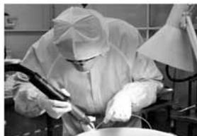
Figure2 ふっ素樹脂の溶接加工
