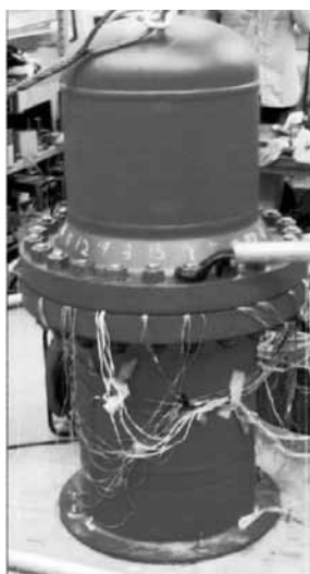
Figure7 20インチ管フランジ締結体の写真 (ボルト呼び径M33、ボルト本数N=24、管内径 \phi 476、フランジ外径 \phi 775)
