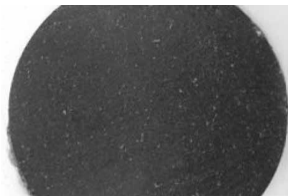
Figure15 H0880材窒素暴露試験後Oリング断面
