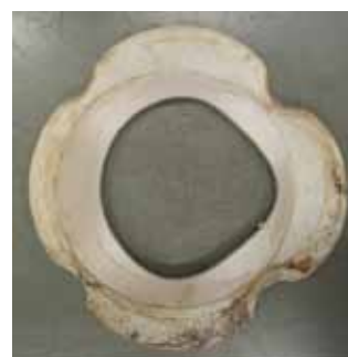
Figure1 締付け不足による変形
