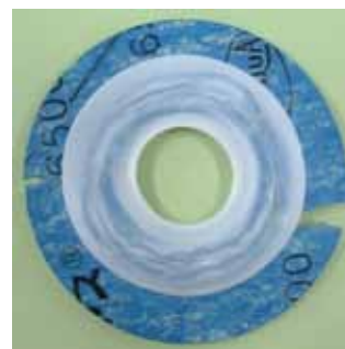
Figure2 過剰締付けによる圧壊 1)
