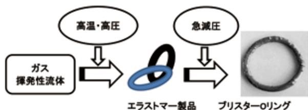
Figure1 ブリストー発生メカニズム
