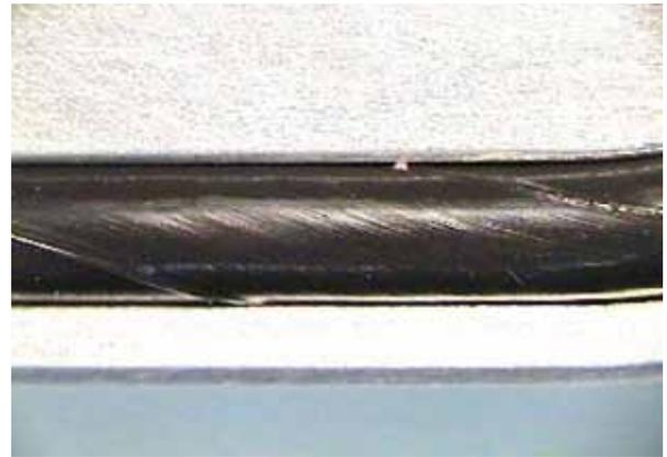
Figure1 転動したゲートシール部O-リング
