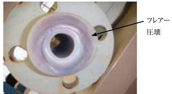
Figure6 ガasket選定によるライニング材破損および薬液漏洩
