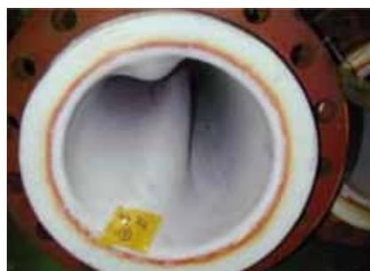
Figure2 ライニング材の陥没現象が発生
