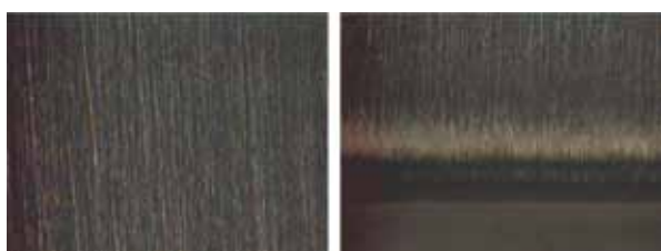
#600 倍率250 Ra0.57 #1000 倍率250 Ra0.13 Figure10 ステンレス板のバフ研磨後の表面状態
