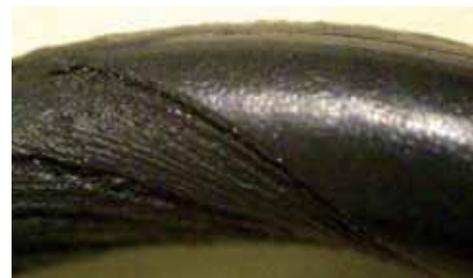
Figure5 高压容器用O-リングの転動によるむしろ
