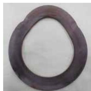
Figure3 片締めによる変形
