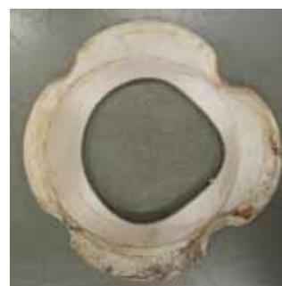
Figure1 締付け不足による変形
