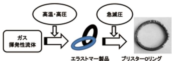
Figure1 ブリストア発生メカニズム
