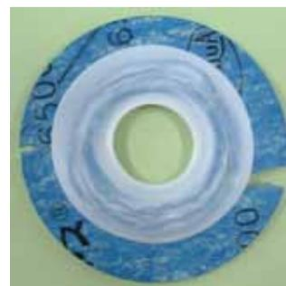
Figure2 過剰締付けによる圧壊<sup>1)</sup>
