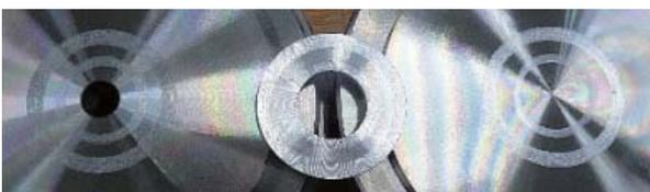
Figure5 压缩试验后的密封垫片与法兰面
