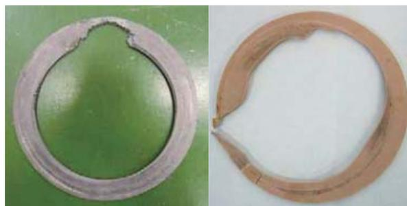
Figure3 软质密封垫片侵蚀的示例
