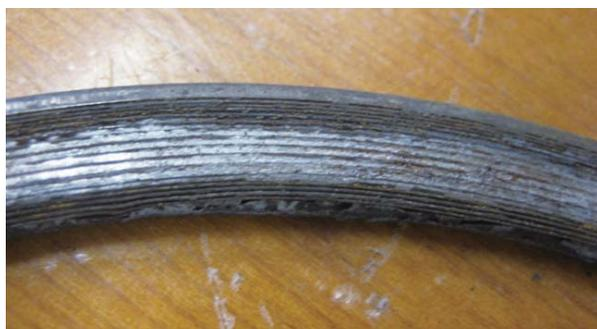
Figure2 缠绕密封垫片氧化消失的示例
