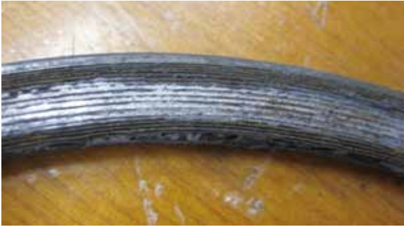
Figure2 うず巻形ガスケット酸化消失の例
