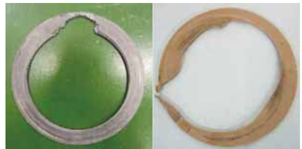
Figure3 軟質ガスケットエロージョンの例
