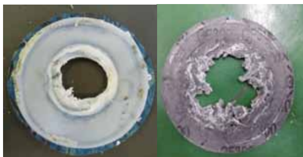
Figure1 樹脂系ガスケット花咲現象の例
