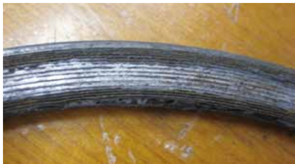
Figure2 うず巻形ガスケット酸化消失の例
