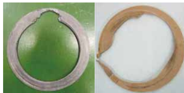
Figure3 軟質ガスケットエロージョンの例
