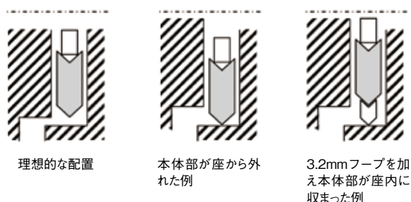
Figure2 うず巻形ガスケットとフランジ座の位置関係
