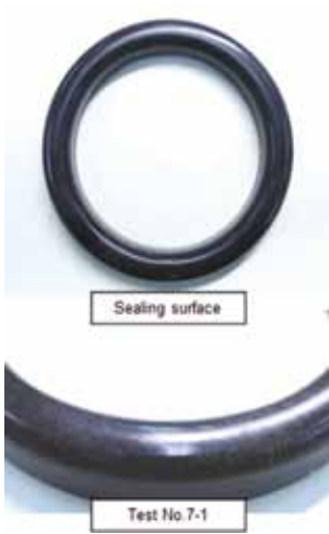
Figure9 Test No. 7-1 泄漏试验后试样照片
