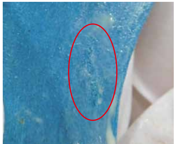
Figure 4 改良版密封膏的压缩断裂试验在100MPa时，发生了压缩断裂
