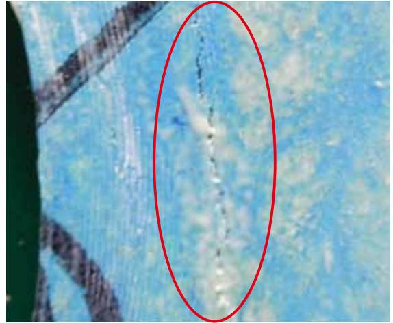
Figure 3 以往的密封膏的压缩断裂试验在100MPa时，发生了压缩断裂
