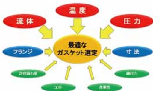
Figure2 ガスケットの選定条件
