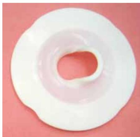
Figure6 ふっ素樹脂シートガスケットの変形
