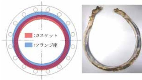
Figure8 ガスケットの芯ずれによる変形
