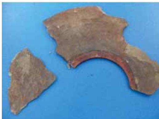
Figure5 ジョイントシートガスケットの硬化割れ
