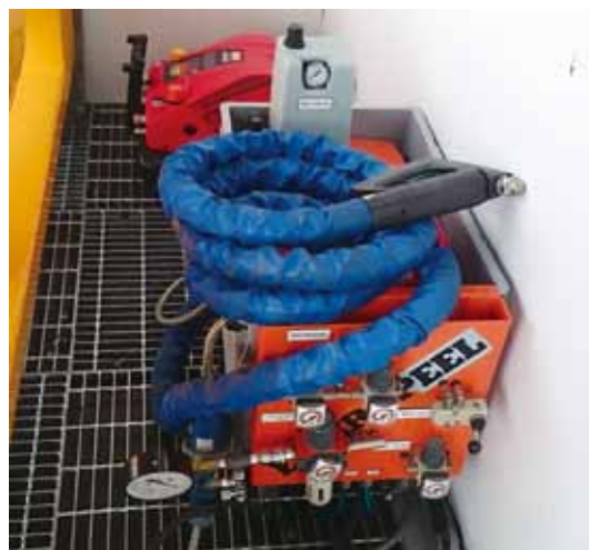
Figure4 特殊防錆施工ユニット
