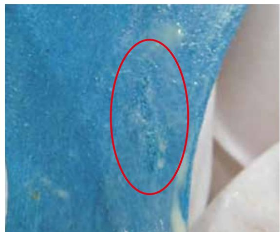
Figure 4 改良版シールペーストの圧縮破壊試験 100MPaで圧縮破壊を確認
