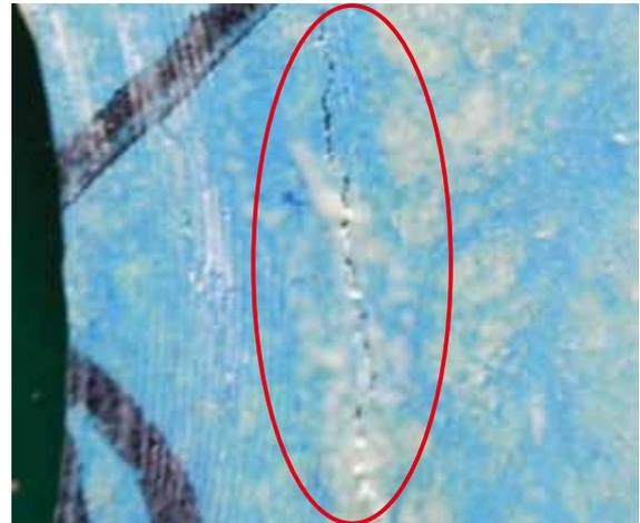
Figure 3 従来品シールペーストの圧縮破壊試験 100MPaで圧縮破壊を確認
