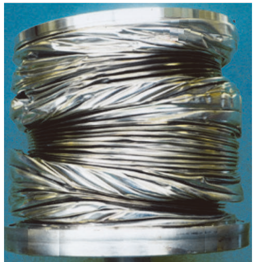
Figure6 波纹管的压曲导致的损坏
