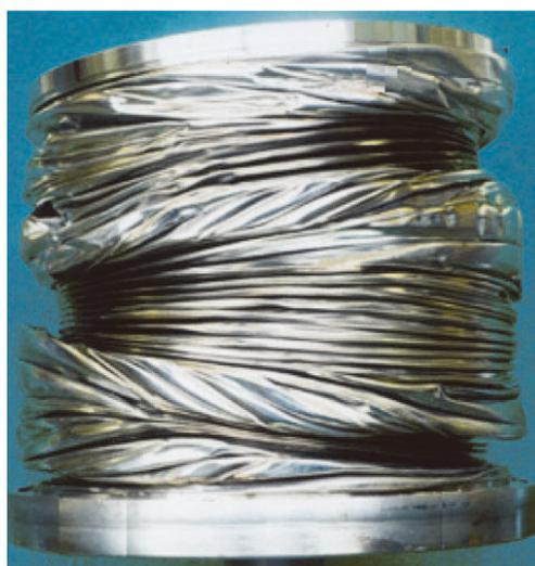
Figure6 波纹管的压曲导致的损坏
