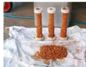
Figure5 フィルターの状態
