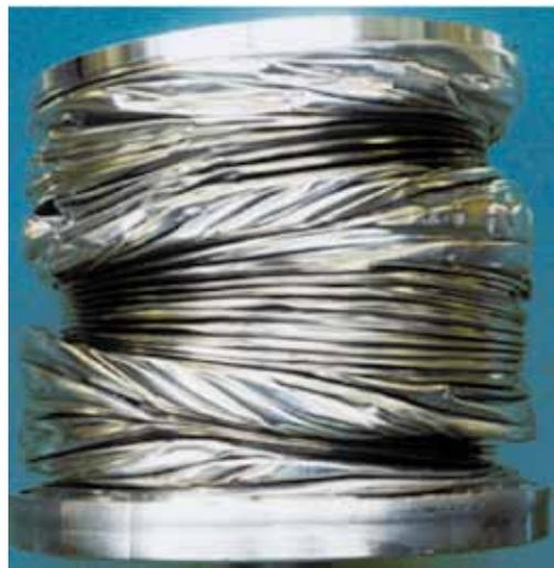
Figure6 ベローズの座屈による破損
