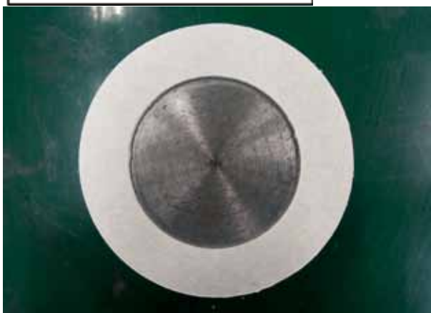
Figure9 面圧100MPa負荷時の外観
