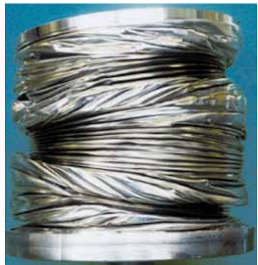
Figure6 ベローズの座屈による破損
