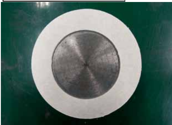
Figure9 面圧100MPa負荷時の外観
