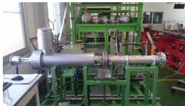
Figure1 体験学習装置 外観 (左側が高温部、右側が低温部)
