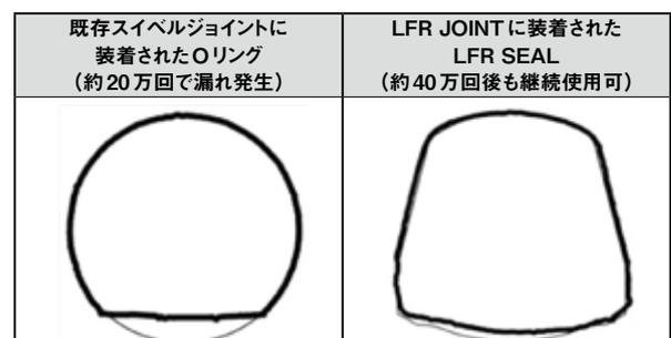
Figure8 寿命評価前後でのシール断面比較
