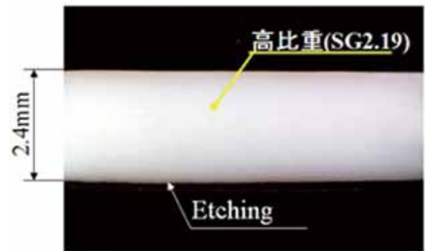
Figure31 PLPシート断面
