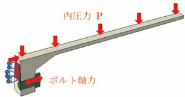
Figure7 FEM解析の境界条件
