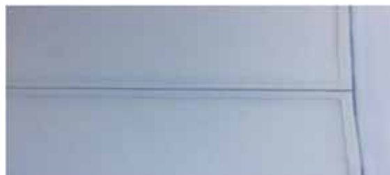
Figure13 当社品 自動溶接(M-PTFE-ET)
