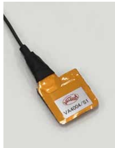
Figure2 薄膜ふっ素樹脂有機圧電素子
