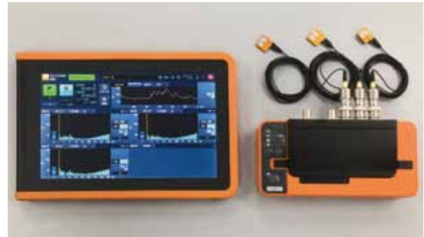
Figure1 振動検知保全システム外観 左 : タブレット端末 右上 : センサー (約2cm角) 右下 : 無線ドック(アンプ)
