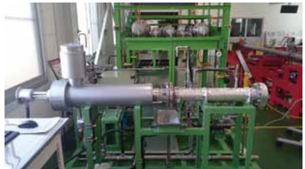
Figure1 体験学習装置 外観 (左側が高温部、右側が低温部)
