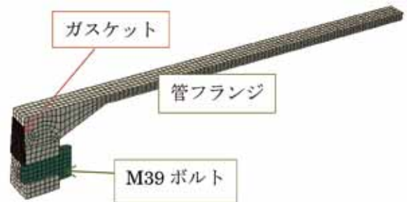
Figure6 管フランジ締結体のFEM解析モデル
