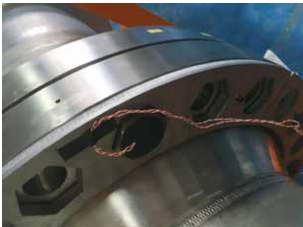
Figure1 24インチ管フランジ締結体の実験装置
