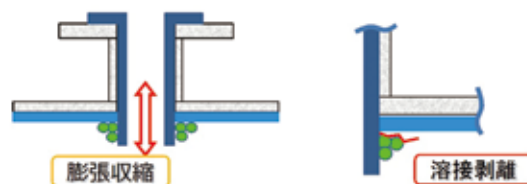
Figure14 ノズルの温度変化による挙動と損例
