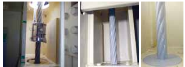
Figure9 根据钢缆表面的形状而开发的浸渍装置的外层被覆防锈工法(本公司专利技术)
