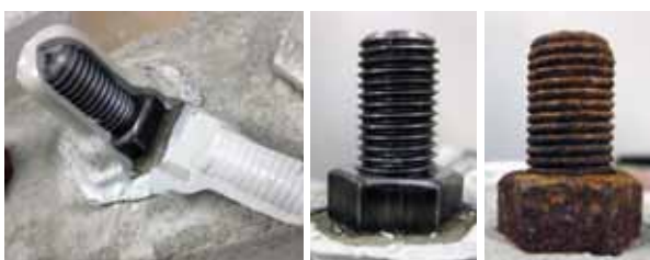
Figure 13 试验情况 有防锈涂覆 无涂覆
