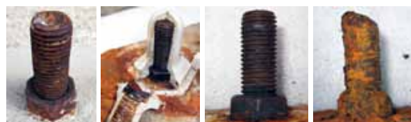
Figure 14 试验情况 有防锈涂覆 无涂覆
