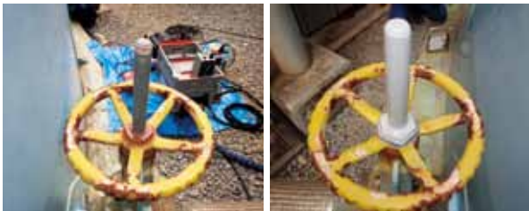
Figure7 轴部防锈 涂覆后(不会固化, 故可操作)
