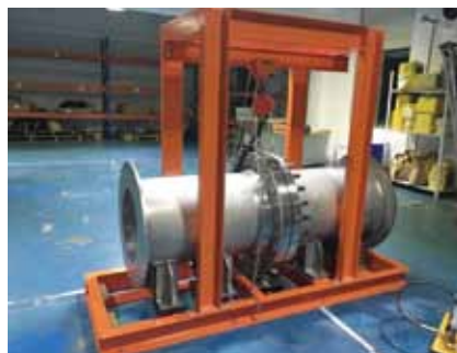
Figure2 试验装置(JPI Class300 24inch)
