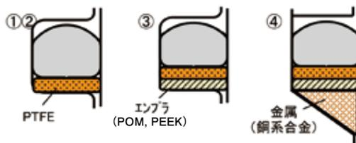
超高圧用バックアップリング構成の機能メカニズム
