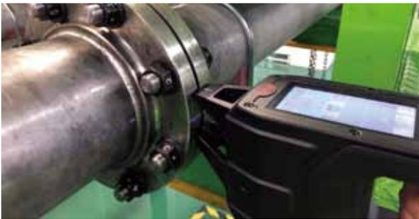
Figure3 フランジ面間・段差の撮像
