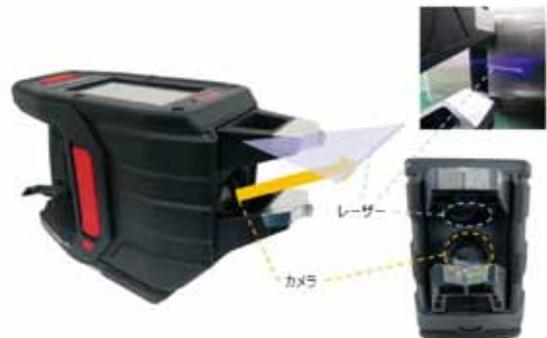
Figure2 GD-PROBER™のレーザーとカメラ
